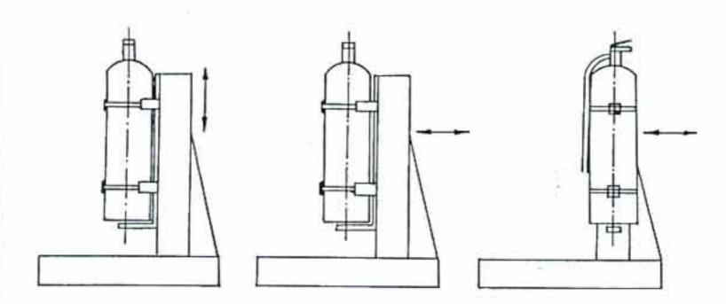
اختبار الذبذبة في الانجاه "ع" Vibration Test in Z - direction
